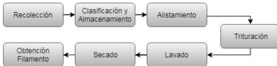
Ilustración 7 Proceso Producción de filamento a partir de Botellas (PET) Reciclado, Elaboración propia
