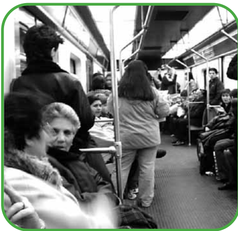
La mayor parte de los sistemas tipo metro utilizan un número reducido de sillas, lo cual permite tener amplias zonas de circulación hacia el interior del vehículo. Foto Metro de Madrid.
